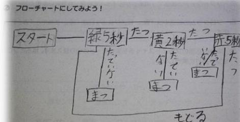
条件分岐を使ってプログラムの動作を整理した図
